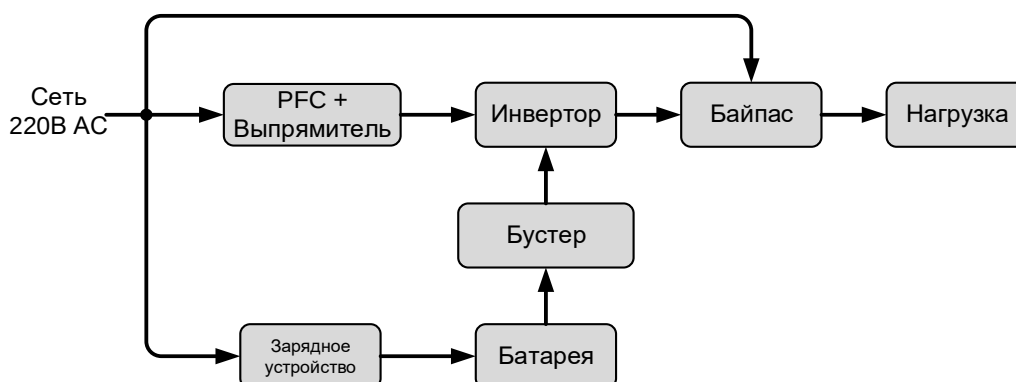
Рис. 2-24 Принципиальная схема работы ИБП
