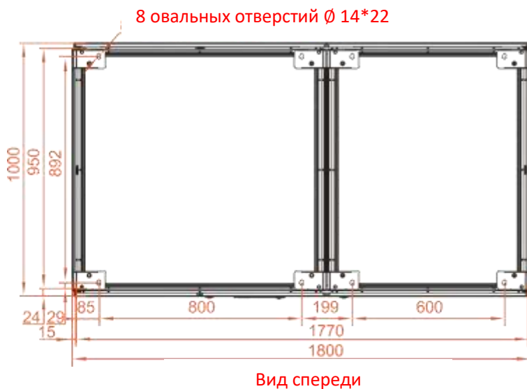
Рисунок 3-14. Размер установочных отверстий подставки для моделей MR331000 и MR331200 (ед. изм.: мм)
